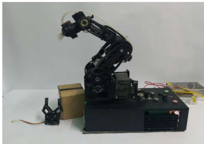
Hình 9. Hình ảnh mô hình thực tay máy Robot sau khi được lắp ráp hoàn thiện
