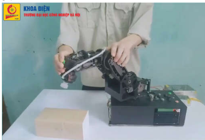
Hình 10. Người vận hành đang tiến hành dạy thao tác cho tay máy Robot
